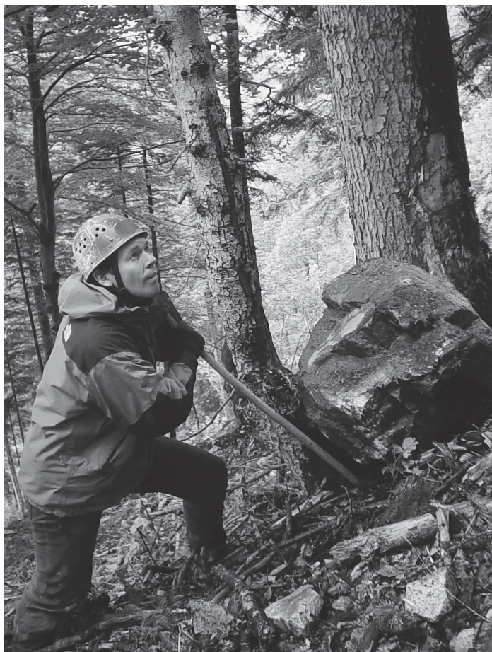
Fig. 1. Sur le site expérimental de Vaujany (Isère, France), le bloc 33 a été arrêté par un petit arbre et cela après avoir été freiné et dévié par d'autres arbres.
