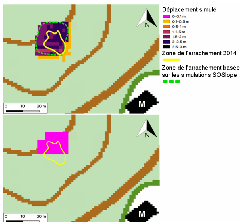
Figure 4.1. – Résultats des simulations de SOSlope avec des rasters d'entrée de 2 m (carte en-dessus) et avec 5 m (carte en-dessous). Le carré noir avec 'M' indique la maison détruite.
