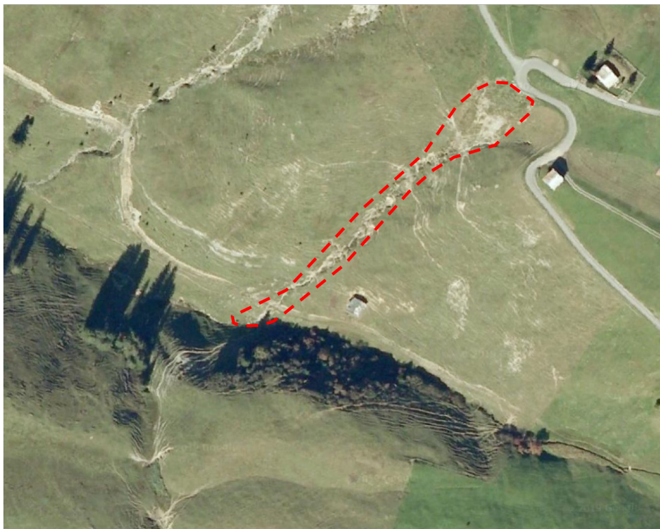
Figure 2.2. – Photo aérienne montrant l'évènement de Saint Antönien (GR, événement n°1) montrant des traces indiquant la forme et l'enveloppe de l'évènement. La ligne rouge en pointillé représente le polygone numérisé tel qu'il a été reçu du service cantonal spécialisé.
