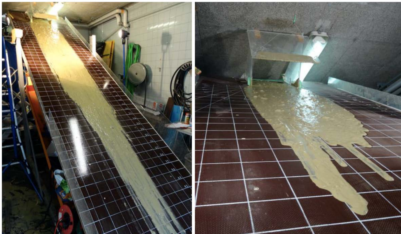
Figure 5.3. – Vue d'ensemble du plan incliné (a), plan rapproché de la boîte de remplissage (b).
